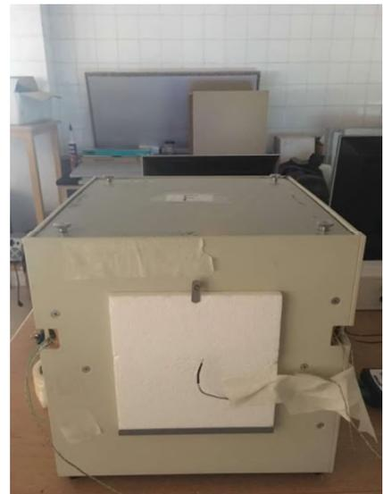
**FIGURA 05** » Elementos utilizados para la realización del ensayo de conductividad térmica. Fuente propia.
