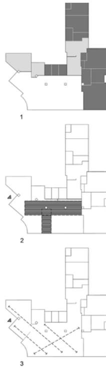
Fig. 24. Estudio de arquitectura de Ramón Vázquez Molezún. Madrid. 1966. Esquemas de operaciones sobre la planta. 1. Compresión/dilatación- en grises espacios intermedios. 2. Asimetría mediante mueble-planero. 3. Diagonales. 4. Caracterización espacios mediante material. 5. Jerarquía espacial mediante la sección. Autoría personal.
