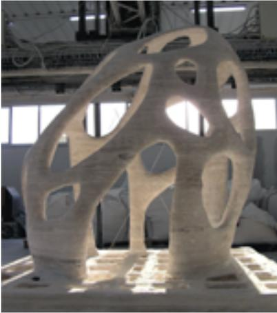
Figura 3. Proyecto Radiolaria, demostrador tecnológico de la impresora D-Shape (Enrico Dini)
